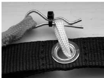
Den vanligaste releasesprinten med korrekt avsnörd inre bukt vilket förhindrar felfunktion.
