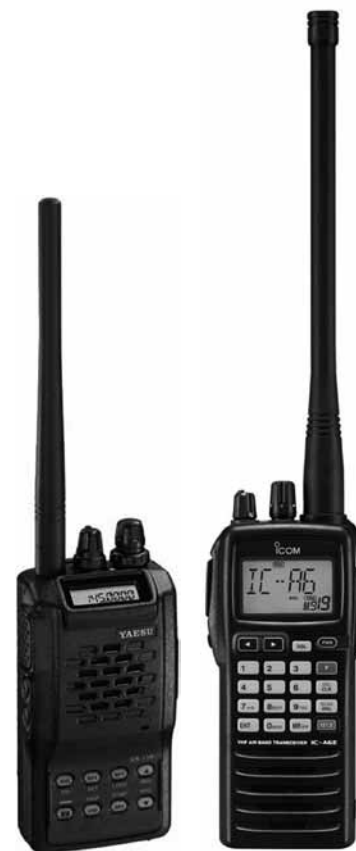
Till vänster en tvåmetersradio av en populär modell, och till höger en flygradio, eller ”luftfartsradio” som det korrekta namnet är.
