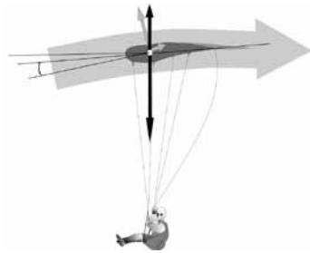
Maxfart med full speed, uppsläppta bromsar. Inställningsvinkeln förändras så att vingen får en brantare glidvinkel och därmed högre fart.
